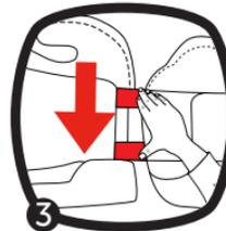
3. Poussez sur le dossier de siège juste au-dessus des crochets jusqu'à ce qu'il soit complètement engagé.
