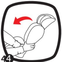
4. Tournez le dossier de siège à une position droite tout en maintenant de la pression juste au-dessus des crochets. Terminez en insérant tout excès de tissu par le haut et le bas du tissu du dossier de siège.
