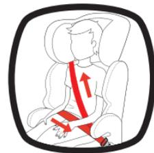
7. Serrez la ceinture de siège en tirant la partie de la ceinture diagonale (au niveau de l'épaule) dans le sens des flèches.
