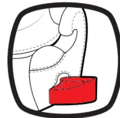
Pivotez vers l'intérieur à la position encastrée et de blocage lorsque non en utilisation.
