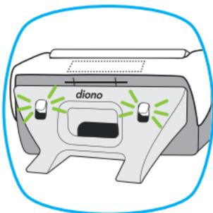
***Pour retirer la base, enfoncez les boutons de dégagement, puis tirez la section supérieure de la base vers l'extérieur afin de la libérer. Détachez délicatement du bas du siège les crochets inférieurs de la base.***
