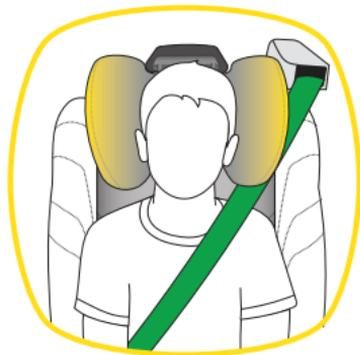
Si la ceinture ne se rétracte pas correctement, vous devez choisir une autre position assise ou continuer à utiliser le siège en mode harnais si l'enfant est toujours dans les limites de taille ou de poids pour une installation face vers l'avant.
