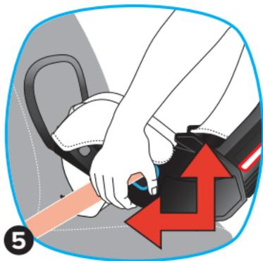
(1 in), il est assez serré. **NE PAS tester en saisissant le dessus ou le dos du siège d'auto. Vérifiez uniquement en saisissant l'ouverture du passage de la ceinture face vers l'arrière.**
