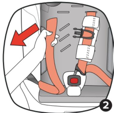
3. À l'aide d'un tournevis standard, localisez les entailles dans le panneau d'accès au harnais, près des guides de ceinture inférieurs, puis retirez le panneau de la coquille du siège. Retirez les anciennes sangles de harnais de chaque côté du siège.
