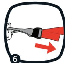
7. **Testez la fixation.** Saisir le côté du siège d'une main où se trouve la ceinture du siège et glisser le siège d'auto d'un côté à l'autre et de l'avant à l'arrière. Si le siège se déplace moins de 2,5 cm (1 po), il est assez serré. Ne pas tester en saisissant le haut ou l'avant du siège.
