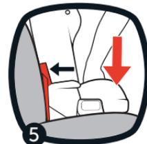
6. **Serrez la sangle d'ancrage supérieur.** Pousser sur le siège d'auto tout en serrant la sangle d'attache pour éliminer tout jeu.
