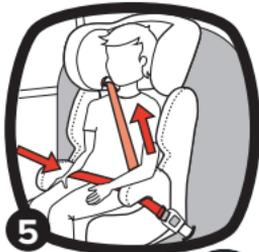
5. Serrez la ceinture de siège en tirant la partie de la ceinture diagonale (au niveau de l'épaule) dans le sens des flèches.
