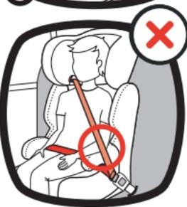
6. Vérifiez si la boucle de la ceinture de sécurité est dans la bonne position. Elle doit être alignée avec les guides de ceinture **ROUGES** sur le côté du siège.
